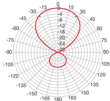
**Guadagno (x: frequenza MHz, y: guadagno ISO dBi) e Pattern (@790MHz)**
